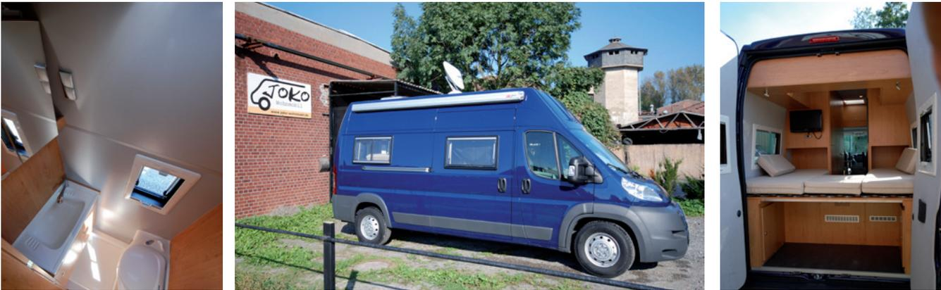
Kastenwagen mit Superhochdachchassis, die Bettebene ist erhöht. Variante mit großer Nasszelle. Sie wurde mit großem Waschbecken ausgestattet.
