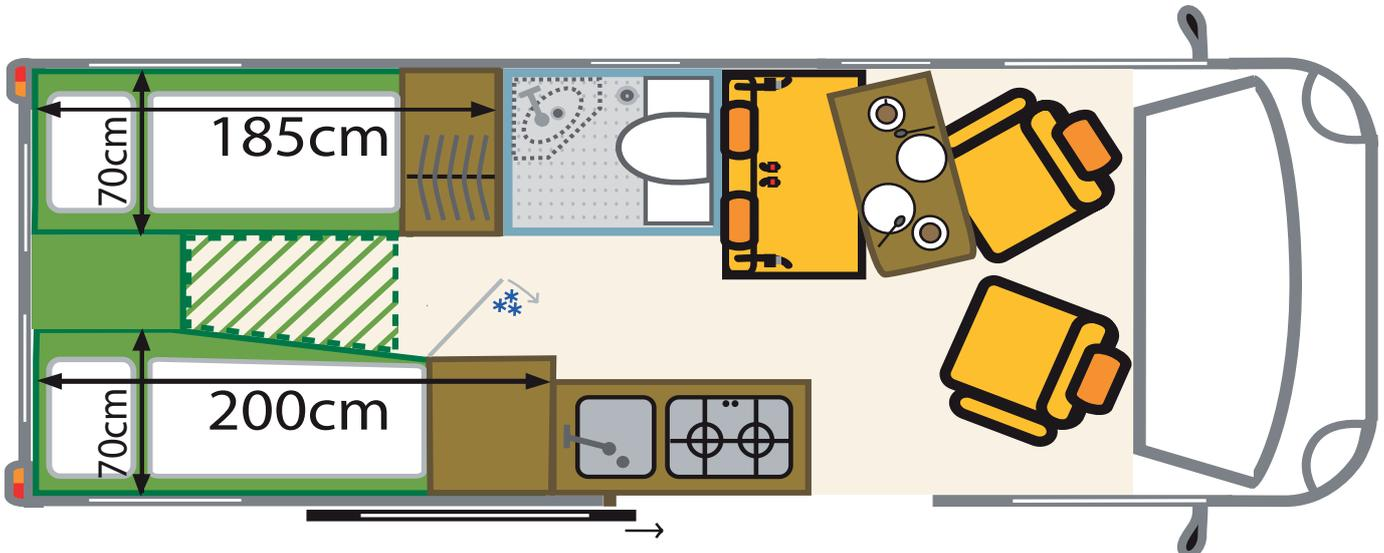
In dieser Variante gibt es in der Dinette eine Rücksitzbank mit zwei weiteren zugelassenen Sitzplätzen. Der Sitzkasten kann als weiteres Staufach genutzt werden. In der Nasszelle kann ein kleines Waschbecken eingebaut werden oder für die bessere Nutzung der Dusche auch weggelassen werden.
